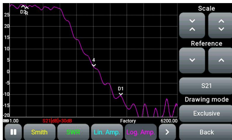
Рисунок 9.14 – Компенсация ослабления сигнала аттенюаторами
