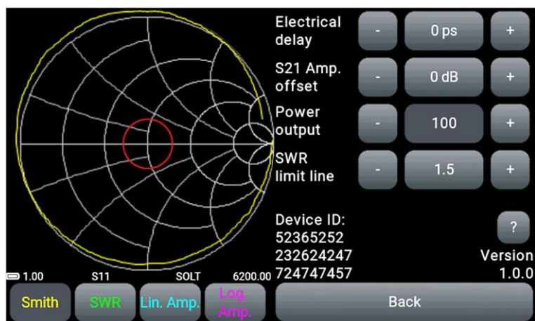
Рисунок 9.12 – Смещение плоскости калибровки дополнительным кабелем
